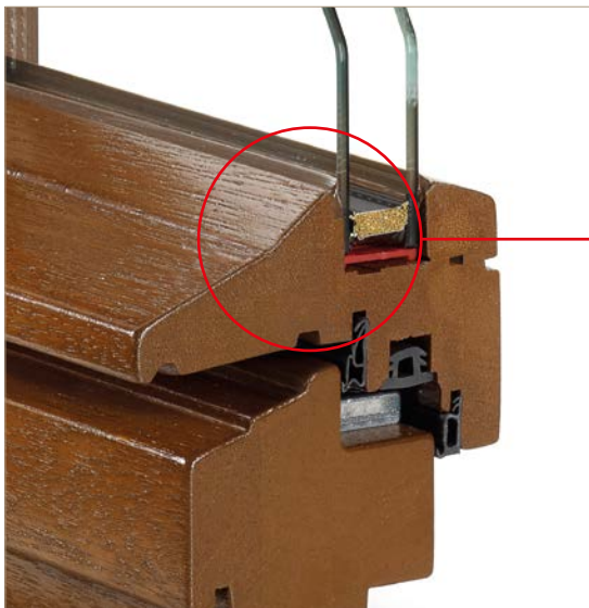
Abbildung mit angefrästem Wetterschenkel – bei Bogenfenstern oder als Sonderwetterschenkel nur in aufgeleimter Ausführung möglich.
